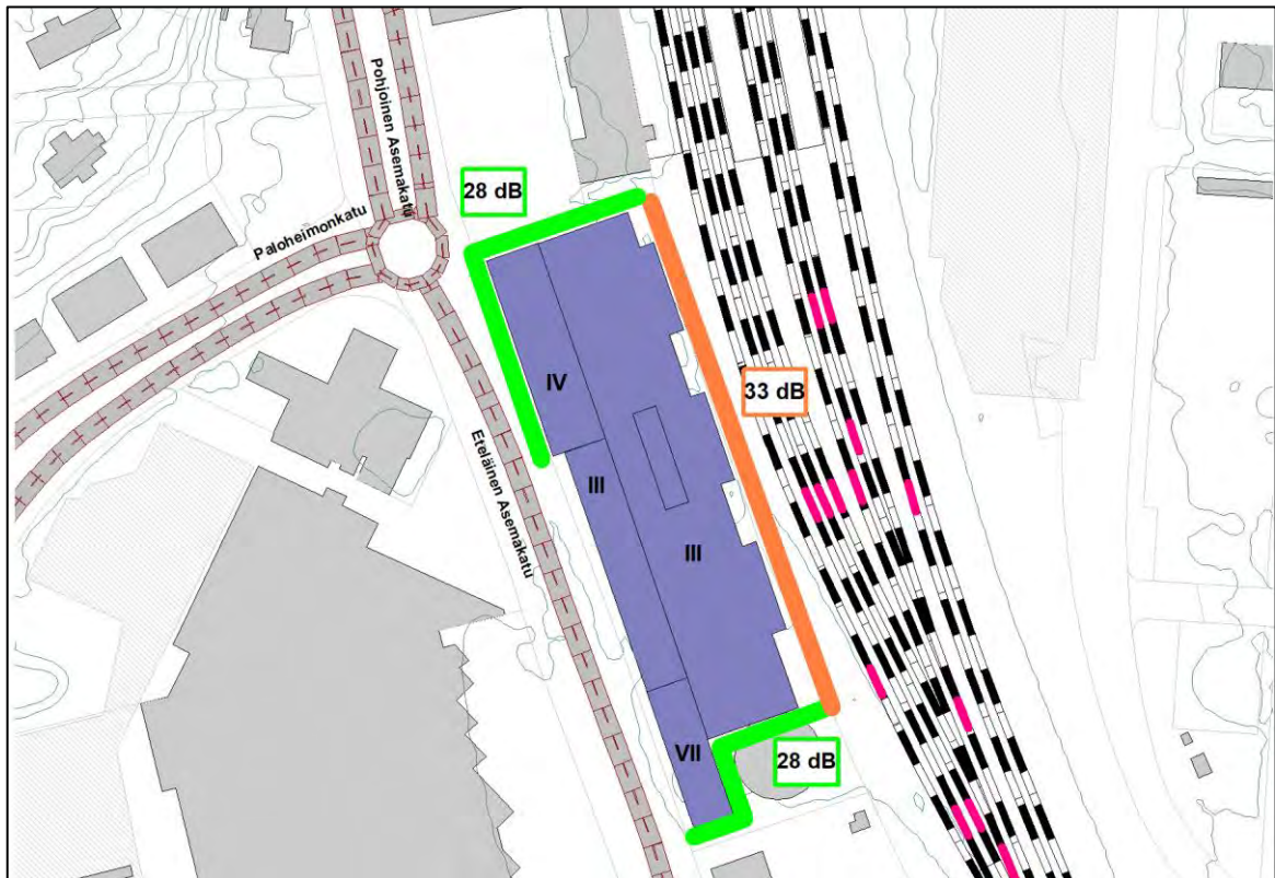
Kuva 3. Julkisivuille muodostuvat 28 dB ylittävät suositukset ulkovaipan äänitasoerovaatimuksiksi \Delta L_{A,vaad} .
