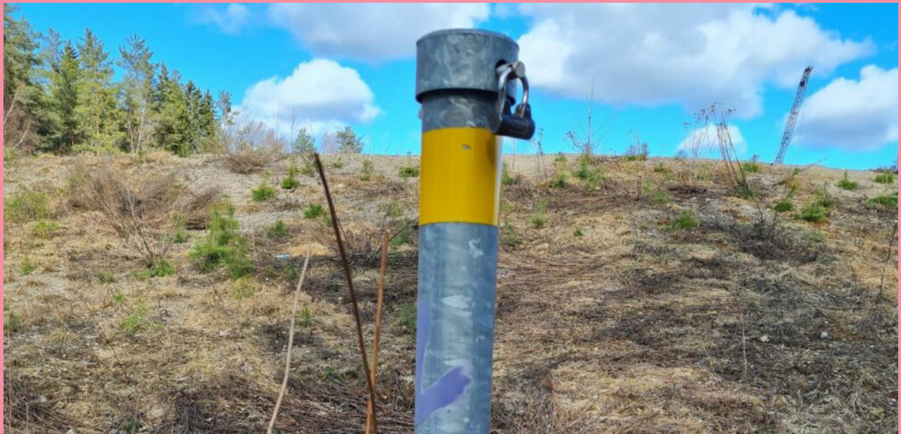
Pohjaveden havaintoputkia käytetään pohjaveden pinnankorkeuden määrittämiseen ja vesinäytteiden ottamiseen. Kuva: Riina Lehtinen
