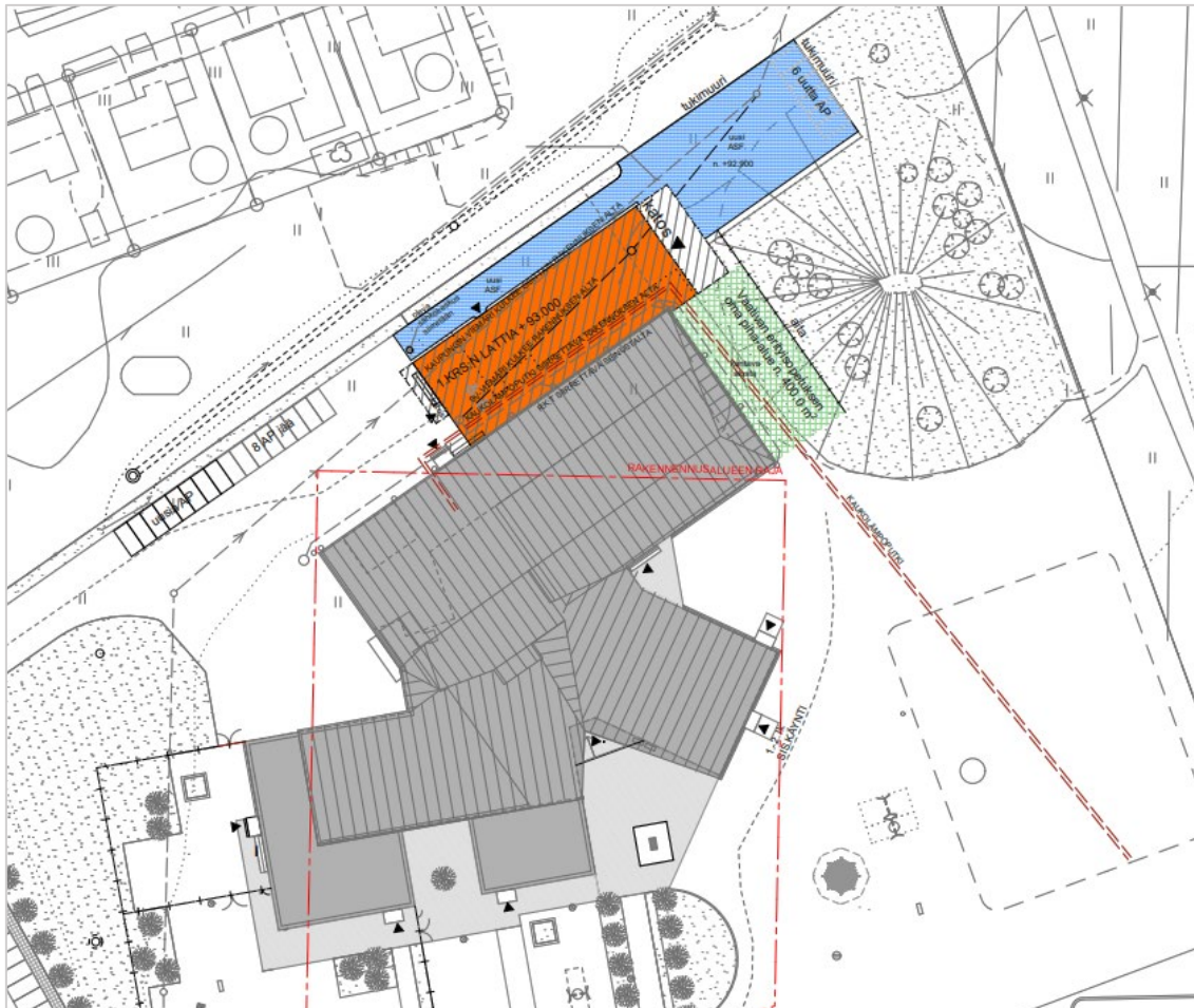
Kuva 13. Ote hankesuunnitelmavaiheen asemapiirroksista, vaihtoehdosta 1, joka on valittu jatko-suunnitteluun. Kuvassa oranssilla esitetty rakennuksen laajennus. Sinisellä saattoliikennealue ja vihreällä TOI-opetuksen piha-alue. Suunnitellut tilavaraukset tarkentuvat jatkosuunnittelussa. (Ajan Arkkitehdit)
