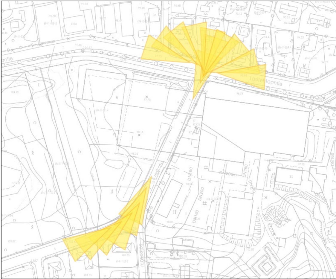
Kuva 29. Ajovalojen vaikutus nykytilanteessa. Ajovalojen viuhkan pituus 50 m ja leveys 26 m vastaa yleisesti autojen ajovalojen 3 luksin kantamaa lähivaloilla.
