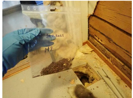
Kuva 36. Rakenneavauksesta otettiin kaksi mikrobinäytettä. M2 turpeesta ja M3 mineraalivillasta. Molemmissa todettiin mikrobikasvua.
