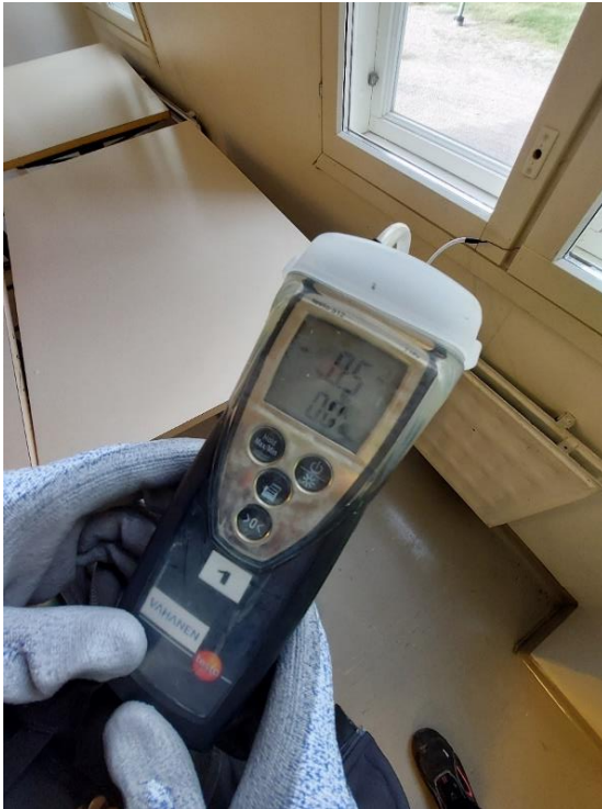
Kuva 82. Rakennuksen painesuhteet olivat tasapainossa hetkellisten paine-eromittausten mukaan. Mittaus 1. kerroksen keittiöstä.
