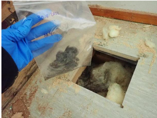
Kuva 39. Rakenteesta otetussa näytteenä M4 todettiin mikrobikasvua.
