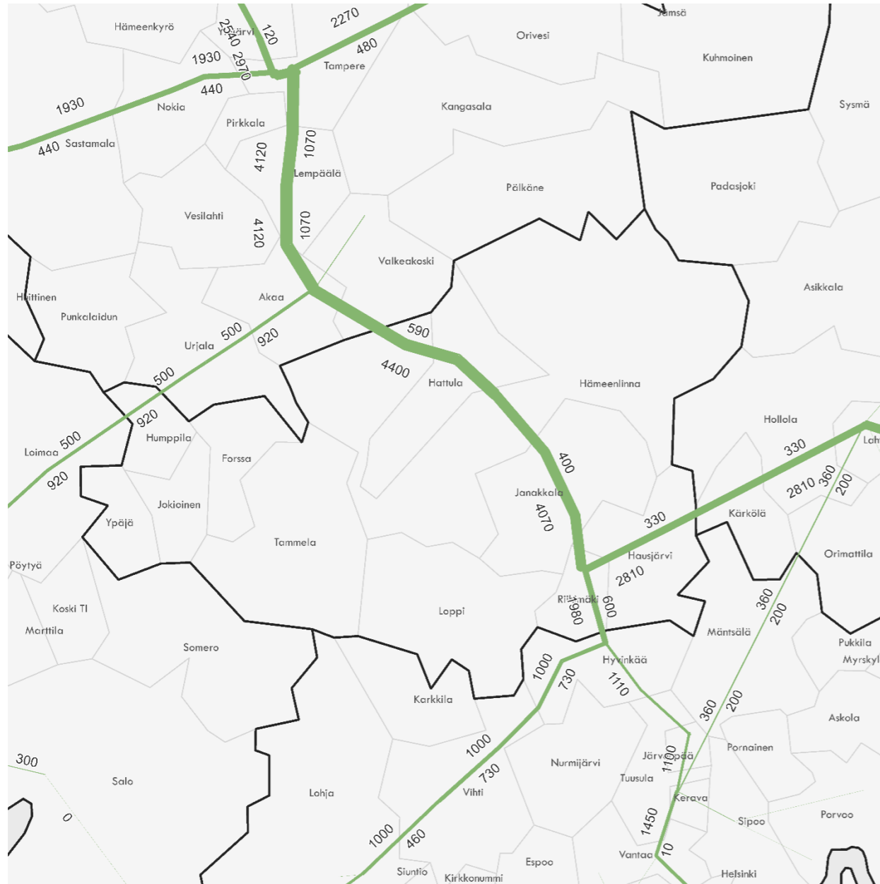
Kuva 2.10. Valtakunnalliseen liikenne-ennusteeseen perustuva ennuste rautatiekuljetuksista vuonna 2040 (1 000 nettotonnia). Luvut on esitetty liikenteen kulkusuunnan mukaisesti.
