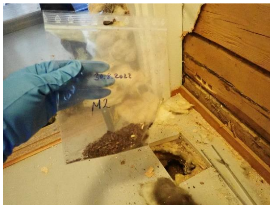
Kuva 36. Rakenneavauksesta otettiin kaksi mikrobiinäytettä. M2 turpeesta ja M3 mineraalivillasta. Molemmissa todettiin mikrobikasvua.
