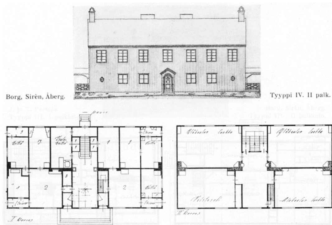
Kuva 7. Mallipiirustus, jonka mukaan Patastenmäen puukoulu on rakennettu vuonna 1924. Piirustuksilla on voitettu toinen palkinto maalauskansakoulujen mallipiirustuskilpailussa. (Arkkitehti-lehti 5/1921)
