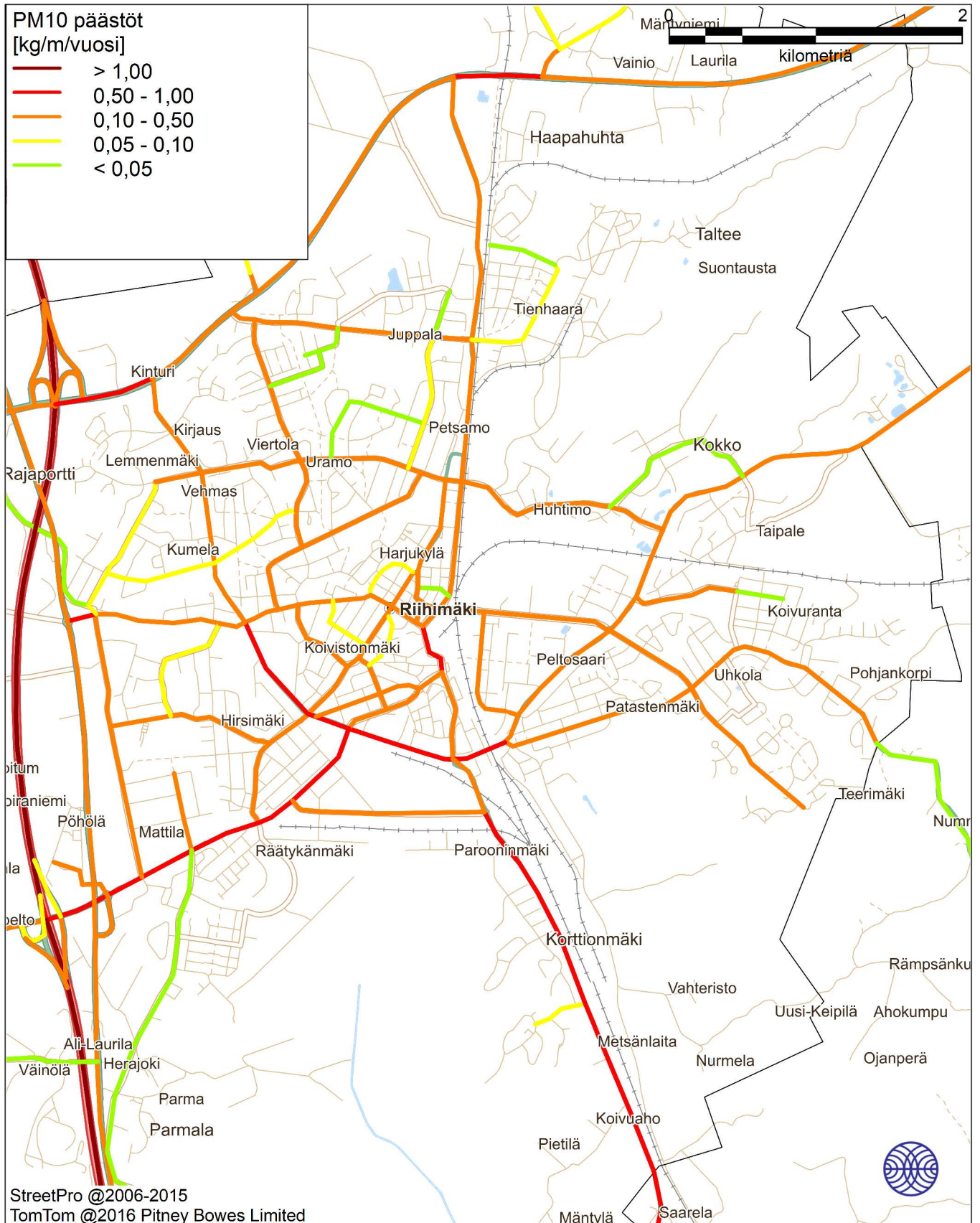
Kuva 56. Autoliikenteen pakokaasujen hengitettävien hiukkasten päästöt [kg/m/vuosi] ja keskimääräinen vuorokausiliikenne (KVL) vuonna 2020.
