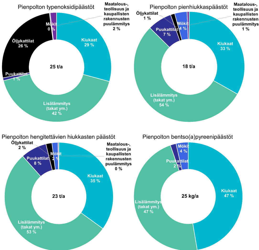
Kuva 26. Riihimäen kiinteistökohtaisen lämmityksen aiheuttamat typen oksidien, pienhiukkasten ja hengitettävien hiukkasten päästöt (t/a) sekä bentso(a)pyreenin päästöt (kg/a) lämmityslähteittäin vuonna 2019.
