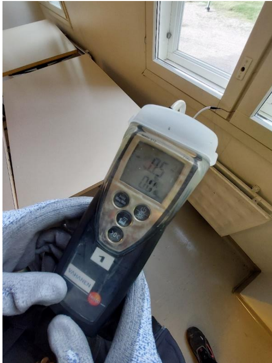
Kuva 82. Rakennuksen painesuhteet olivat tasapainossa hetkellisten paineromittausten mukaan. Mittaus 1. kerroksen keittiöstä.
