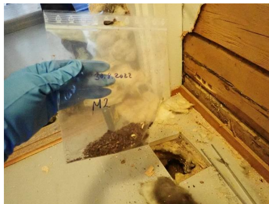
Kuva 36. Rakenneavauksesta otettiin kaksi mikrobiinäytettä. M2 turpeesta ja M3 mineraalivillasta. Molemmista todettiin mikrobikasvua.
