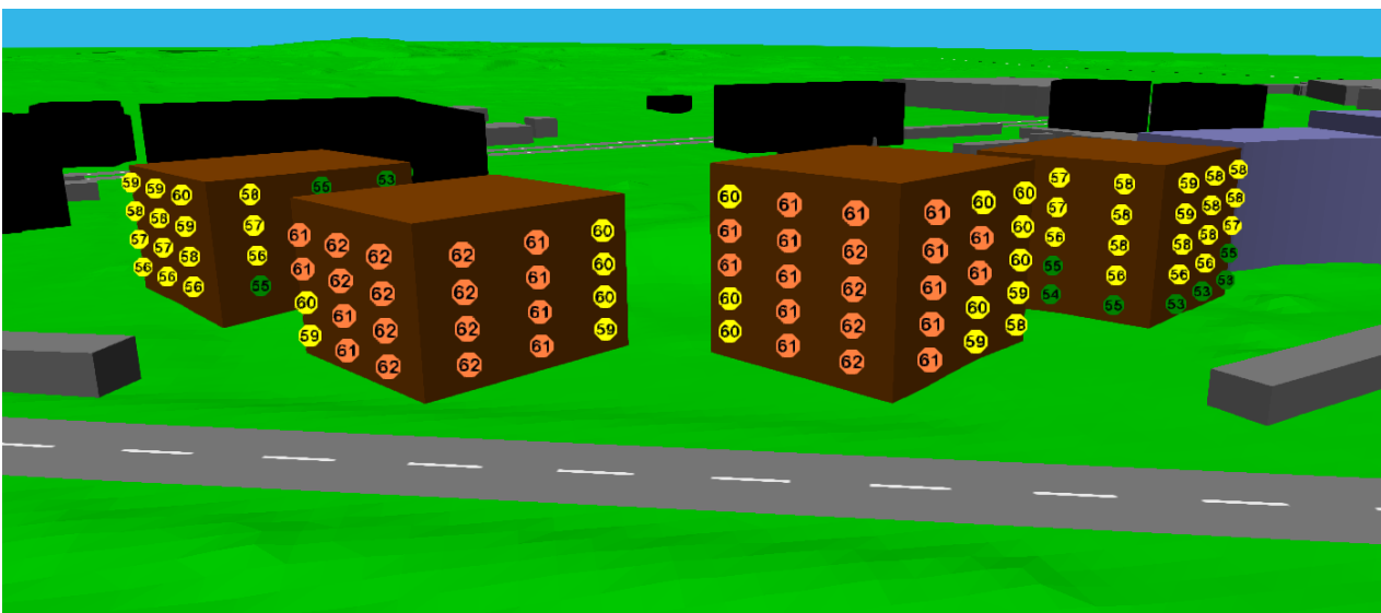
Kuva 3. Julkisivuun kohdistuva äänitaso etelän suunnasta katsottuna.
