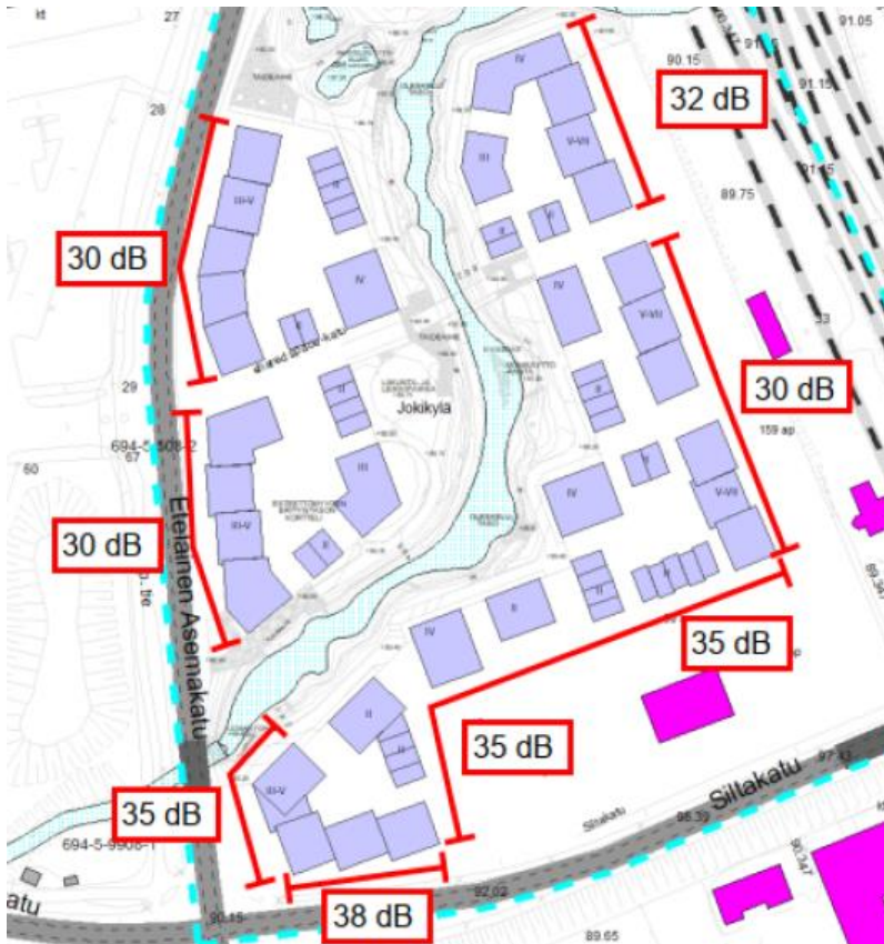
Kuva 25. Julkisivujen äänitasoerovaatimukset (Sitowise Oy, 2023)
