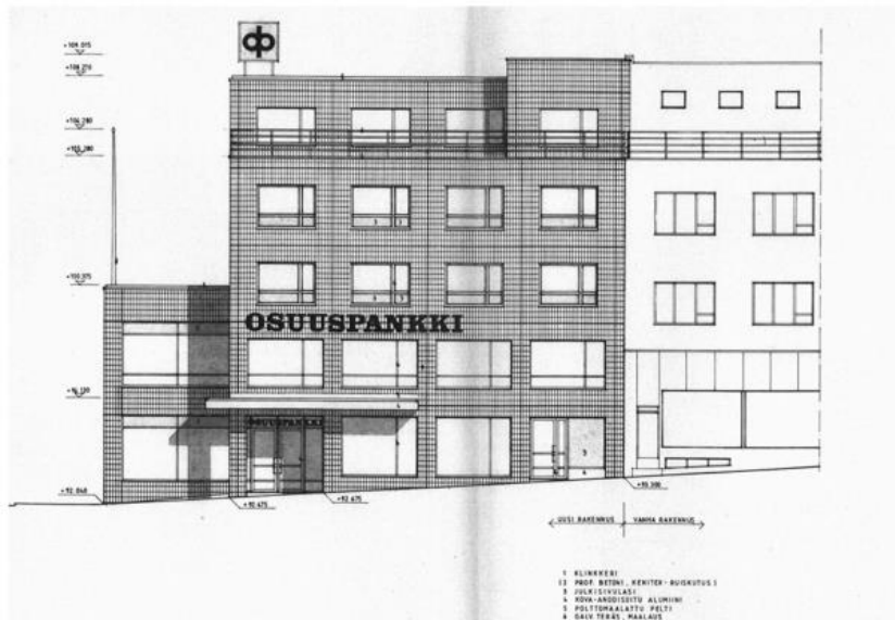
Kuva: Julkisivu Hämeenkadulle. Ikkunoiden epäsymmetrinen karmijako on variaatio viereisen funkistalon ikkunoista. / Iivonen & Aho 1982.
