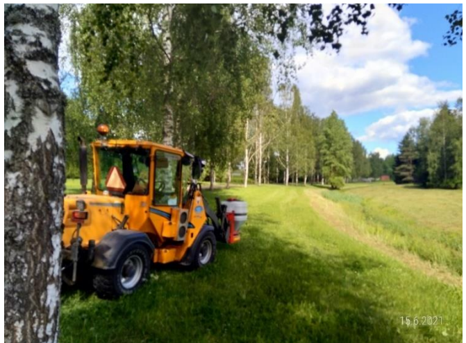
Kuva 8. Keskipakoislevitin RS100 asennettuna Wille 375 -ympäristöhoitokoneeseen (Kulhoranta 2021).
