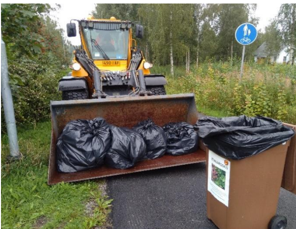
Kuva 2: Etanajäteastioiden tyhjennystä Wille 855 -ympäristöhoitokoneella (Kulhoranta 2021).
