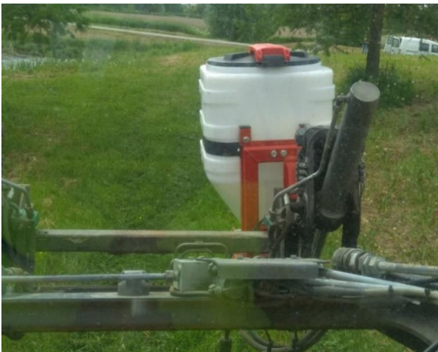
Kuva 8. Keskipakoislevitin RS100 asennettuna Wille 375 -ympäristöhoitokoneeseen (Kulhoranta 2021).
