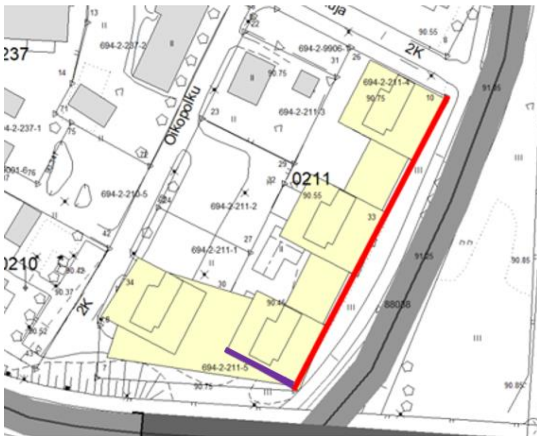
Kuva 5. Suositus ulkovaipan, \Delta L 36dB (punaisella) ja \Delta L 32 dB (violetti), äänitasoero vaatimukseksi. Radan nopeusrajoitukset huomioitu.
